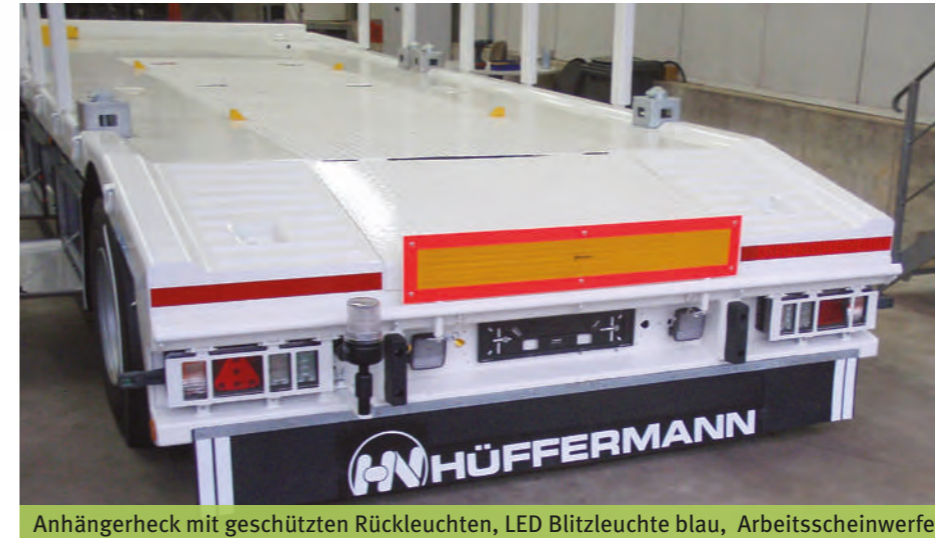
Anhängerheck mit geschützten Rückleuchten, LED Blitzleuchte blau, Arbeitsscheinwerfer
