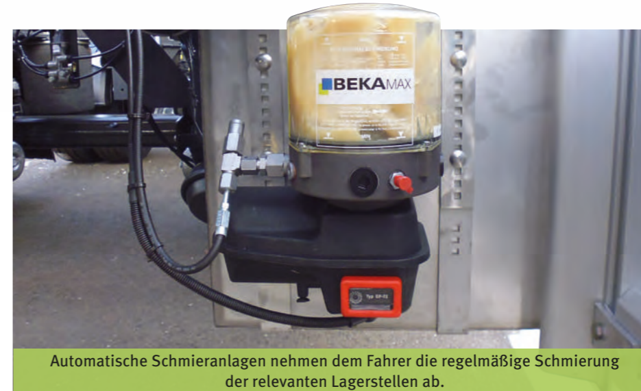
Schmierverteiler an geeigneter Stelle versorgen über einen zentralen Schmier-nippel auch schwer zugängliche Schmierstellen, z.B. am Drehgestell.
