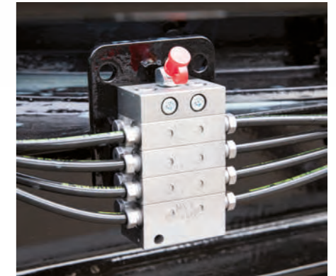
Schmierverteiler an geeigneter Stelle versorgen über einen zentralen Schmier-nippel auch schwer zugängliche Schmierstellen, z.B. am Drehgestell.
