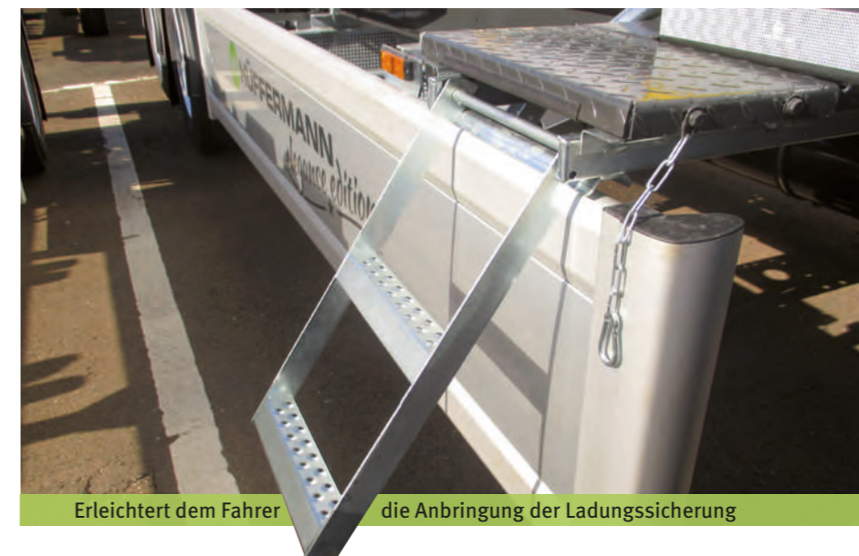
Ladehilfe beim einfachbereiften Anhänger
